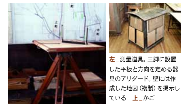
左_測量道具。三脚に設置した平板と方向を定める器具のアリダード。壁には作成した地図(複製)を掲示している 上_かご 体模型や、先祖が嫁いだときに持ってきた和ダンス、家を解体したときに寄贈された古道具など懐かしいお宝もたくさん展示しています。 案内人：川上三雄(歴史民俗資料館職員)
